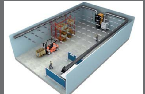
U-förmiges Push/Pull-System mit 1 Filtereinheit und 1 Lüfter
