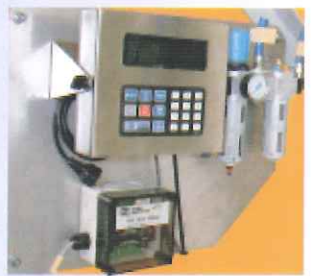
Wiegevorrichtung überwacht Füllgewicht
