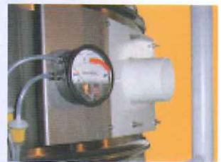
Anzeigerät misst Filterwiderstand
