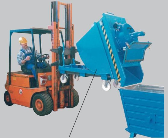
Vorabscheider zur Erhöhung der Sammelkapazität bzw. Verwendung des bauseitigen Transportsystems. VEK-500, Inhalt 0,5 m<sup>3</sup>
