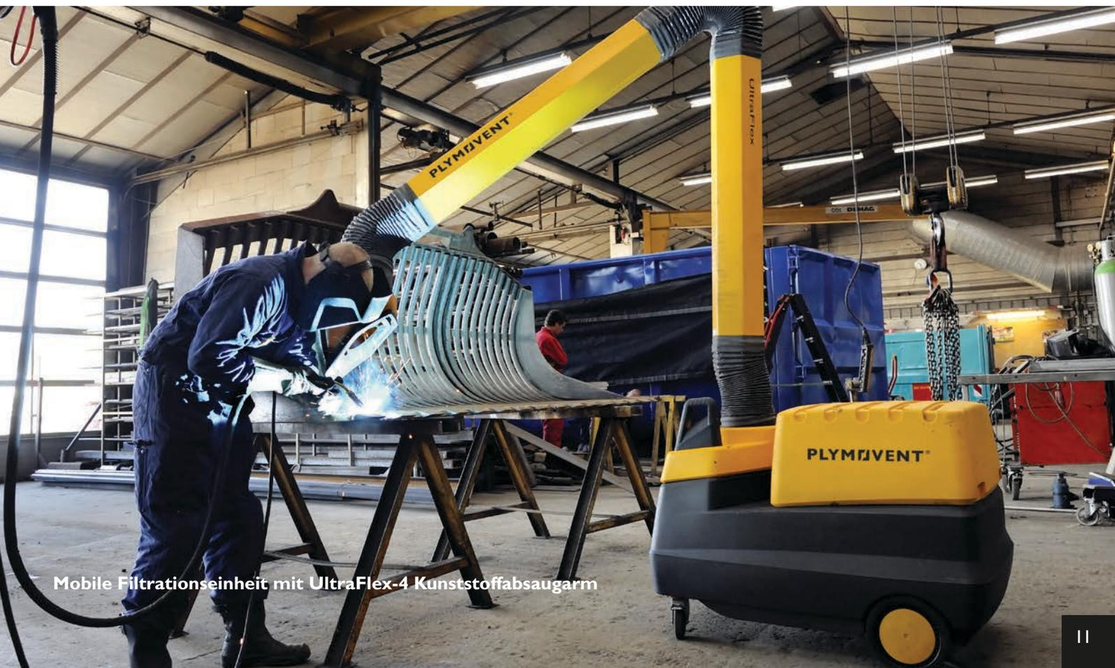
Mobile Filtrationseinheit mit UltraFlex-4 Kunststoffabsaugarm
